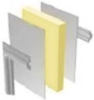
Groupe unique de panneaux de porte grâce aux matériaux utilisés dans les versions vitrée ou non vitrée. Il se caractérise par un cadre supplémentaire en aluminium (en profil extrudé spécialement pour l'entreprise Veyna), qui forme un motif décoratif et constitue un élément qui maintient la partie vitrée. Cette technologie permet le remplacement du vitrage si nécessaire. Les panneaux s'intègrent parfaitement à une architecture classique et élégante.
